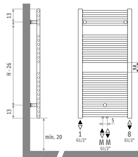
Werkdruck: max. 16 bar (1600 kPa)
